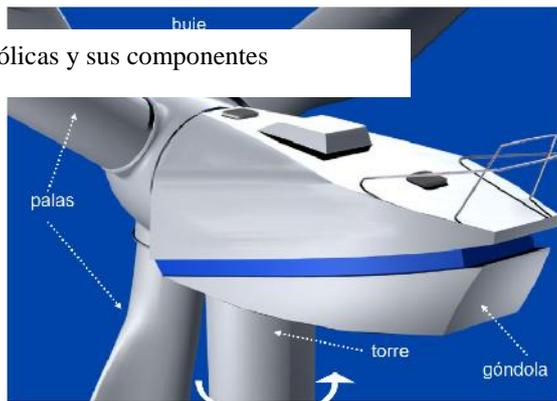
Ilustración 14: Componentes de Máquinas Eólicas
