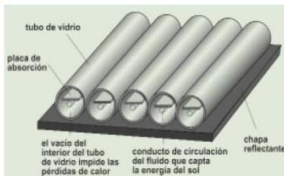
Ilustración 3: Esquema de Captadores de Vacío
